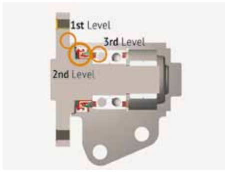
Protecție cu trei niveluri de înaltă fiabilitate a rulmenților
