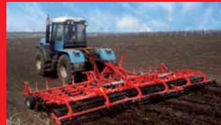
CERVONEȚ Cultivator pentru prelucrarea înainte de însămânțare
