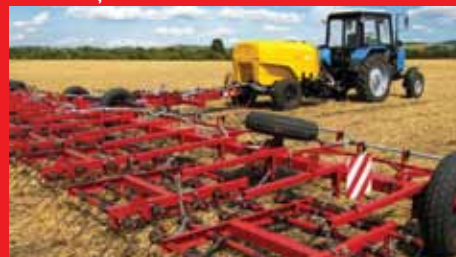
REAL Complexe pentru introducerea în sol a preparatelor pentru protecția plantelor și a îngrășămintelor minerale lichide
